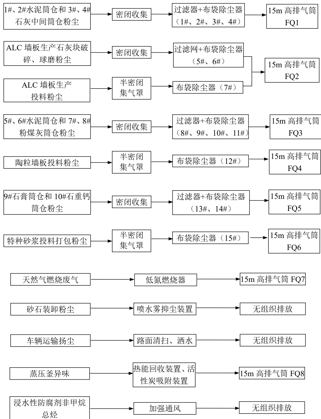
图 7-1 项目废气收集及处理管线图
